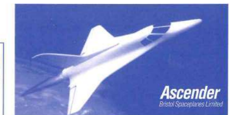
●プリストル・スペースプレーンズ社「アセnder」100kmまでマッハ4で飛びます。
